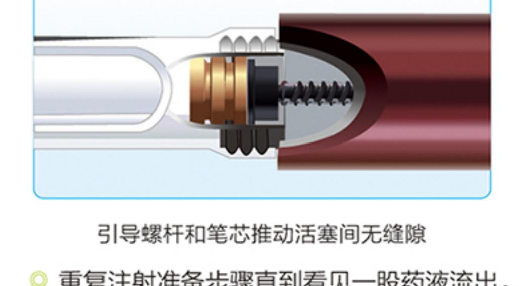
引导螺杆和笔芯推动活塞间无缝隙
